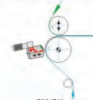
刮涂系统 Slot die coating
